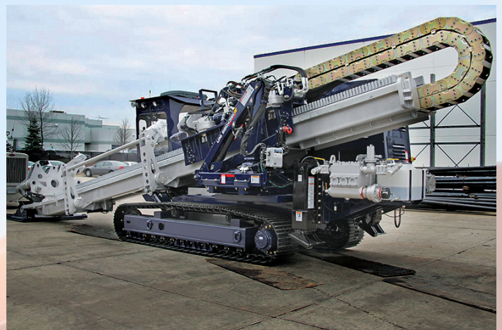
嵌套Gortrac SRC 系列拖链保护和引导这台水平定向钻机的通用HDD™软管
