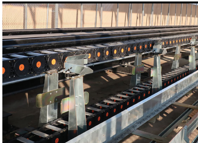
ARS系统消除了长达300英尺的行程中对导向槽的需要和相关磨损，同时将牵引力和安装时间平均减少50%。
