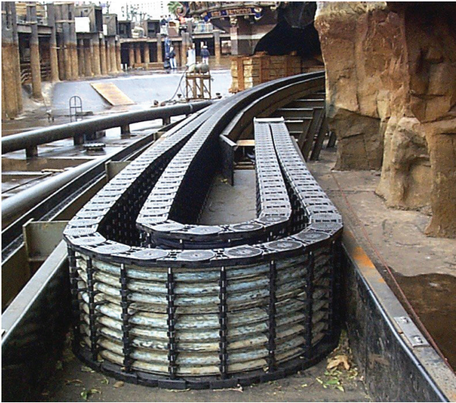
嵌套式Nylatrac ® 模块化TL拖链在娱乐景点侧面安装的情况下运行。为长行程设计的旋转托架。
