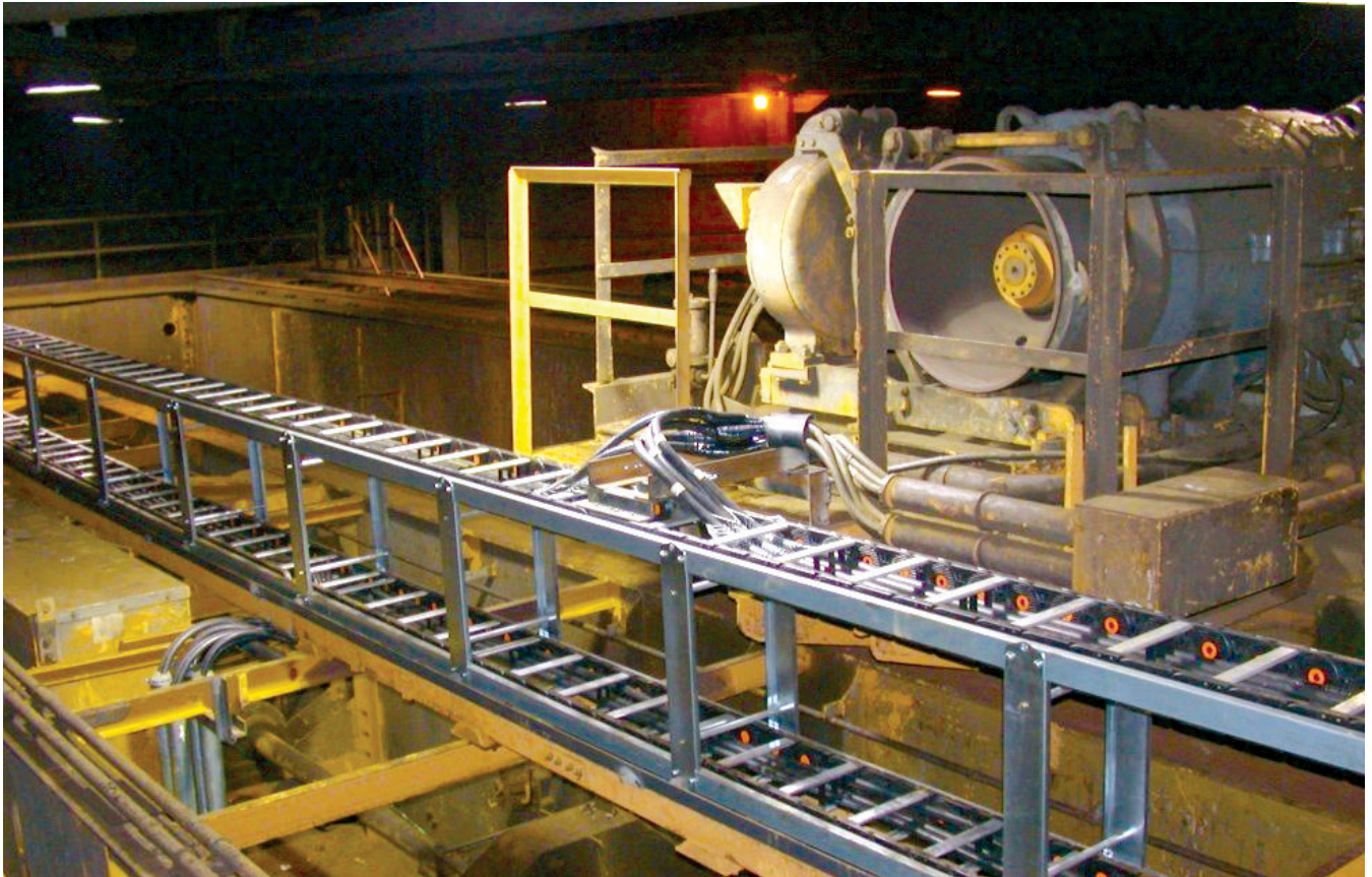
Dynatect设计的完整电缆托架系统包括一个高速轧制小车和Nylatrac ® 模块化TL托架，可在钢厂实现长距离行驶。
