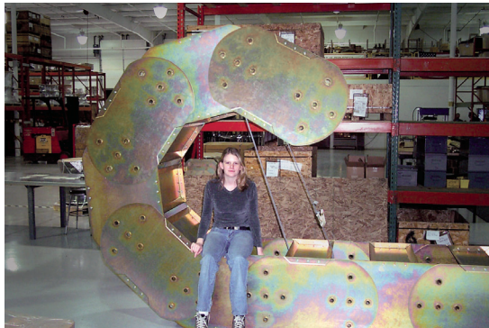
图示: 用于纸张转换应用的24"钢制XL拖链。XL拖链可提供定制尺寸。
